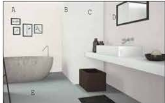
wall A: corner blanco wall B, C & D: avenue blanco floor E: microcemento gris 60x60
